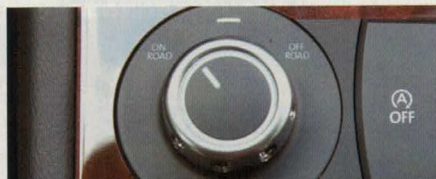
2 TRANSMISSIONS 2 transmissions: avec ou, comme illustré, sans réducteur (4Motion).
